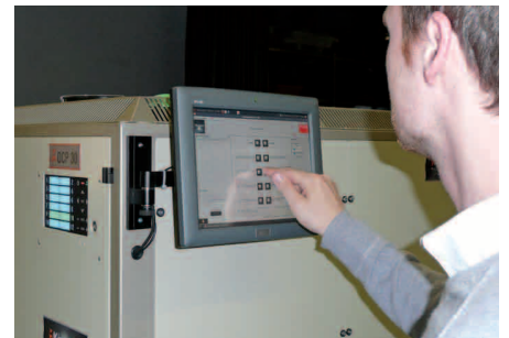
Das optionale, ausklappbare Touchscreen-Display bietet zusätzliche Bedien- und Kontrollfunktionen.
