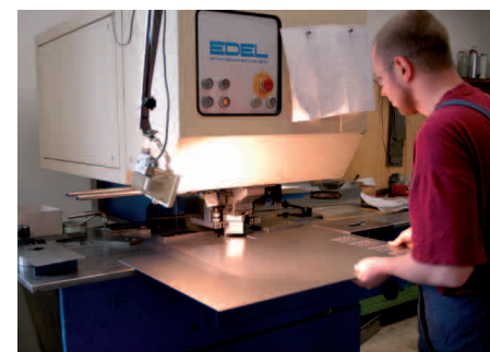
Individuelle Blechfertigung an einer Stanzmaschine
